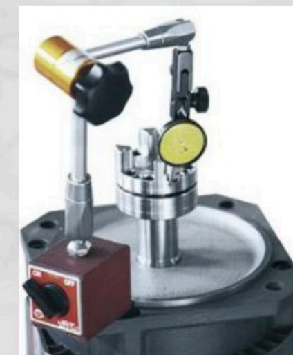
Verificação do acoplamento do eixo-árvore
