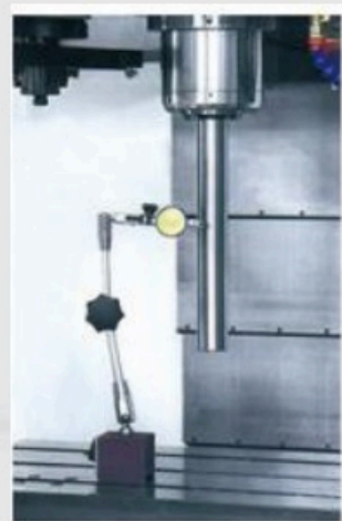
Verificação de batimento do eixo-árvore
