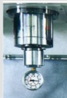
Medição da força de retenção da ferramenta
