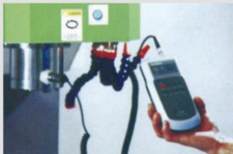
Verificação de vibração do eixo-árvore
