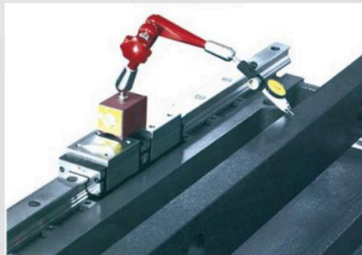
Verificação de paralelismo das guias lineares
