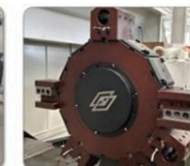
Torre com ferramentas acionadas
