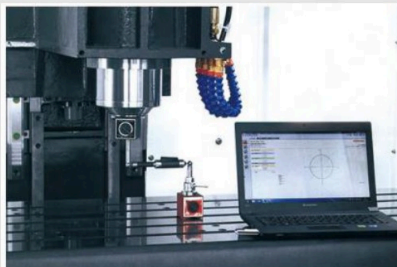
Ensaio de circularidade com ballbar
