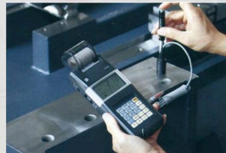
Ensaio de dureza dos fundidos
